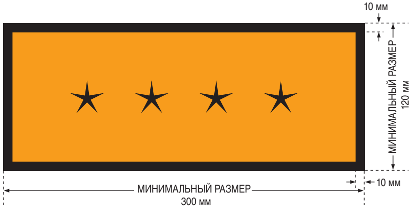
РИС. 7. Информационное табло для отдельного указания номера ООН. Цвет фона знака – оранжевый, рамка и номер ООН – черные. Знак "****" обозначает место, где должен помещаться соответствующий номер ООН для радиоактивного материала согласно таблице 1.
