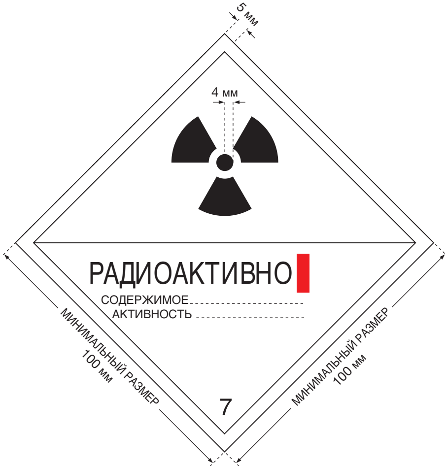
РИС. 2. Знак опасности категории I-БЕЛАЯ (I-WHITE). Цвет фона знака – белый, цвет основного знака радиационной опасности (трилистника) и надписей – черный, цвет полосы, обозначающей категорию – красный.
