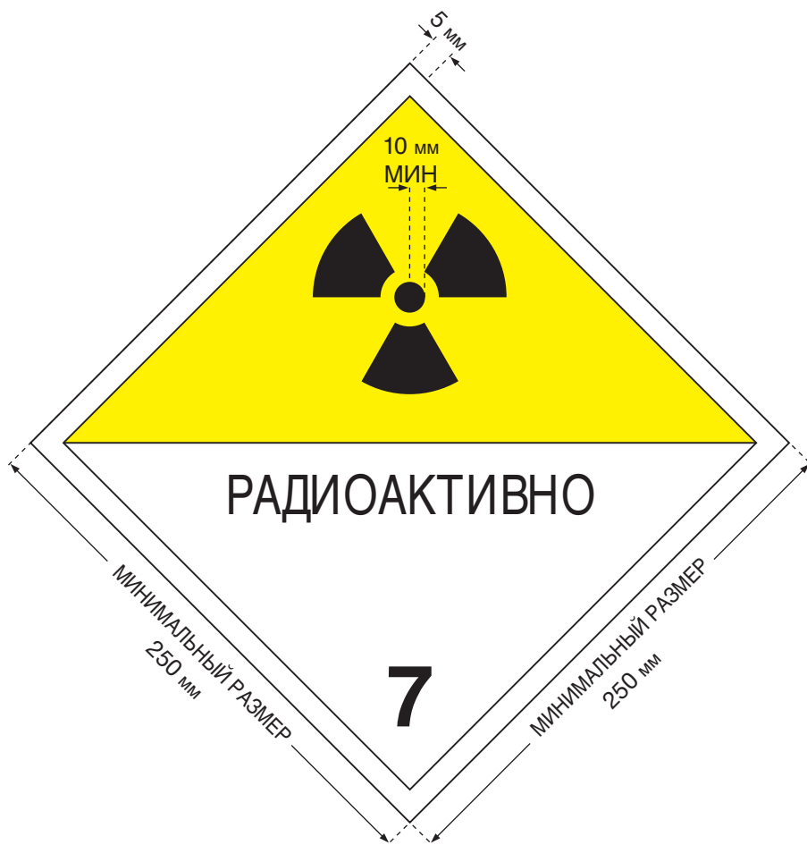
РИС.6. Информационное табло. За исключением случаев, оговоренных в пункте 567, минимальные размеры должны соответствовать размерам, указанным на рисунке; при использовании других размеров следует сохранять соответствующие пропорции. Высота цифры "7" должна быть не менее 25 мм. Цвет фона верхней половины табло – желтый, нижней половины – белый, цвет основного знака радиационной опасности (трилистника) и надписей – черный. Использование слова "РАДИОАКТИВНО" ("RADIOACTIVE") в нижней части не обязательно, что позволяет применять это табло для изображения соответствующего номера ООН для груза.
